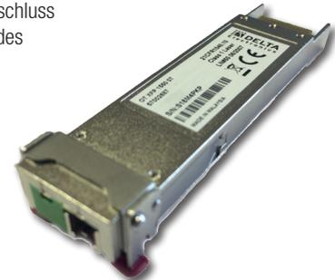
Das OT XFP DM 1550 09 Sendemodul kann die mittlerweile veralteten 1310 nm und 1550 nm Broadcast Sender ersetzen.
