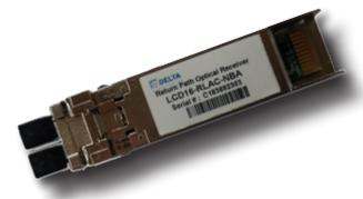
Das SFP Modul zeichnet sich durch seinen sehr geringen Stromverbrauch aus, erreicht eine sehr große Rückweg Empfänger Dichte und ist DOCSIS 3.1 Upstream kompatibel. Das low power range SFP Modul eignet sich für RFoG Applikationen und das high power range Modul ist optimal für HFC Applikationen einsetzbar.
