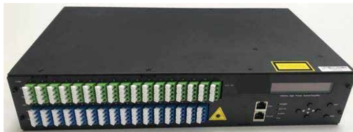
Bauform 19" , 1 or 2 HE bis zu 64 optische Ausgänge möglich
